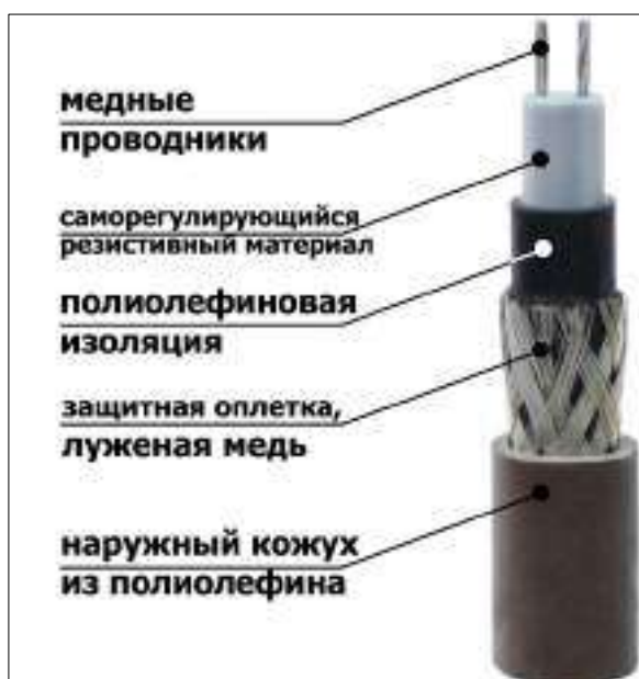
Рис. 25. Конструкция саморегулирующегося термокабеля
