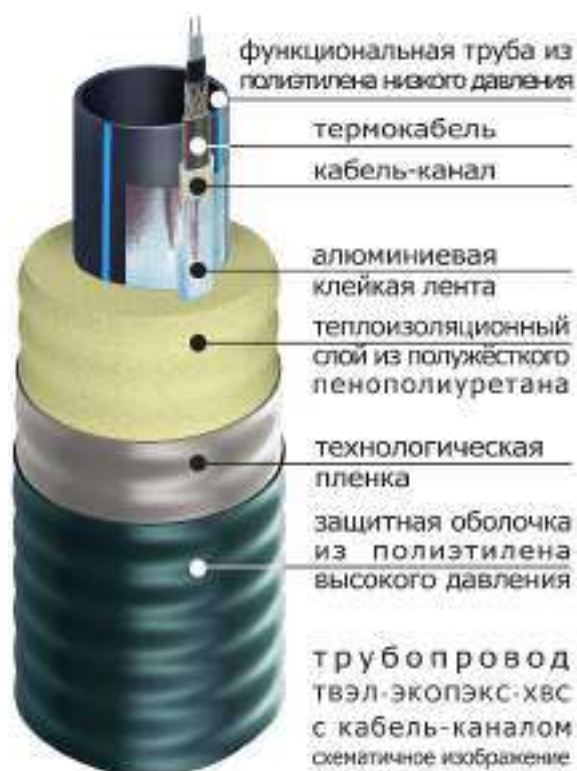
Рис.1. Конструкция трубы ТВЭЛ-ПЭКС-ХВС
