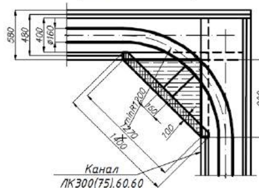
05) Закругление двухтрубной прокладки трубопроводов ТВЭЛ-ПЭКС в оболочке 125мм, 140мм, 160мм
