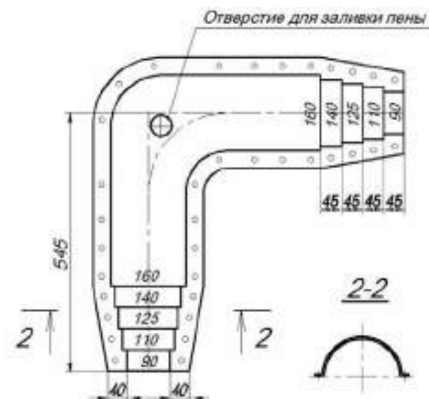
Рис. 27 Кожух для изоляции угольника, универсальный (для диаметров оболочек 90-160 мм)
