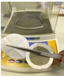
Рис. 1 Фильтр АФА-ВП слева пост до начала лесных пожаров, справа вовремя
