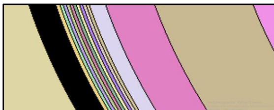
Рис. 1. Схема деления периферийного слоя топливной таблетки в эффективной ячейке
