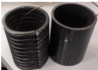
Рис.1. Образец бракованного трубопровода (с резьбой и без резьбы)
