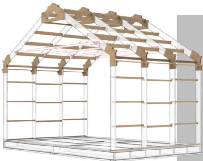
■ Системы адаптеров позволяют за несколько дней возвести силовой каркас, и уже со второй недели строительства перейти к утеплению и обшивки фасадными материалами.
