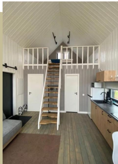
Отсутствие чердачного перекрытия позволяет ощутить объем и пространство, открывая свободу для применения множества индивидуальных интерьерных решений. При этом отсутствие чердачного перекрытия позволяет достигать такой конструктивной особенности соединения кровельного и стенового покрытия, которая позволяет уйти от затрат на устройство наружной водосточной системы, и затрат на подшивку карнизной части дома.
