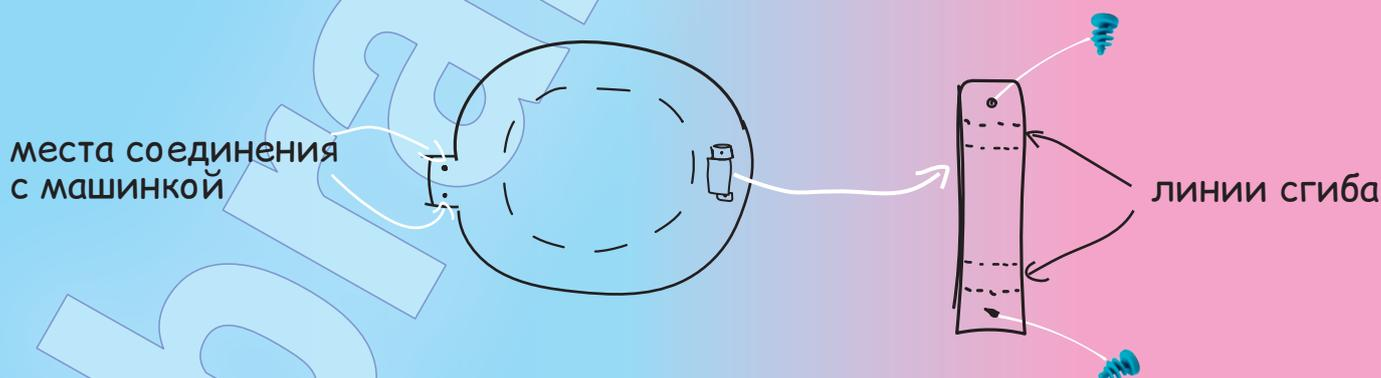
Шаг 4. Вырезаем из картона небольшой круг - из него мы сделаем переключатель программ. В центре круга отмечаем кольцедырком место соединения с машинкой и с помощью шурупчика прикрепляем к машинке. Рисуем на круге указательную стрелку.
