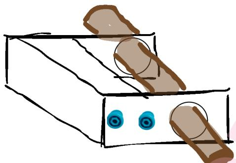
7. Теперь соединяем 2 тубы вместе, чтобы получился погрузочный кран. Берем втулку и делаем в ней круг, чтобы вошла туба, вставляем тубу и закрепляем шурупчиками.
