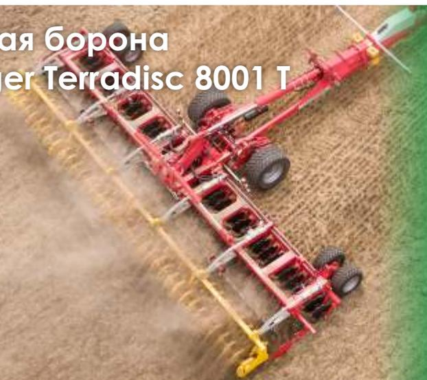
TERRADISC гарантируют ведение по заданной рабочей глубине. Минимальные затраты на быстроизнашивающиеся детали благодаря прочным дискам диаметром 580 мм и толщиной 5 мм. Высокая производительность за счет высокой скорости работы.
