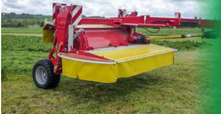
Прицепная косилка NOVACAT T с рабочей шириной 3,46 м отлично подходит для использования с небольшими тракторами. Прицепной вариант с подвеской не требует подъемной силы, а значит позволяет работать на менее мощных тракторах.
