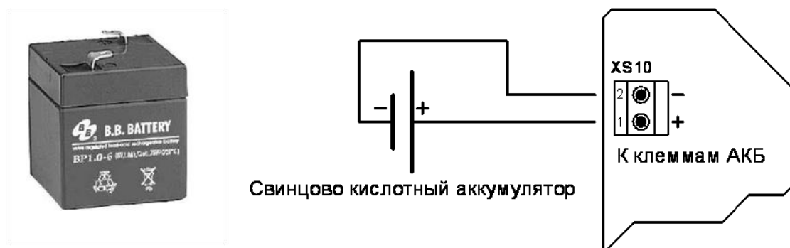
Рис. 4 - Подключение к контроллеру внешней аккумуляторной батареи.
