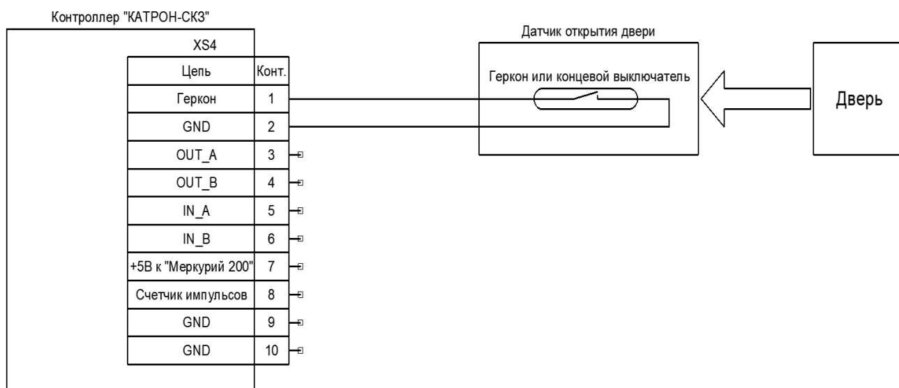
Рис. 9 - Схема подключения к контроллеру датчика открытия двери.
