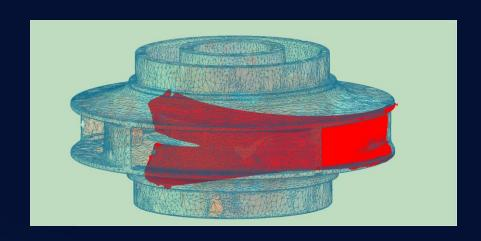
• Инновационные технологии: Успешно применяем разработанные нашим КБ технологии измерения труднодоступных внутренних полостей, что позволяет в некоторых случаях избежать дорогостоящей томографии, демонтажа и разрезания деталей.
