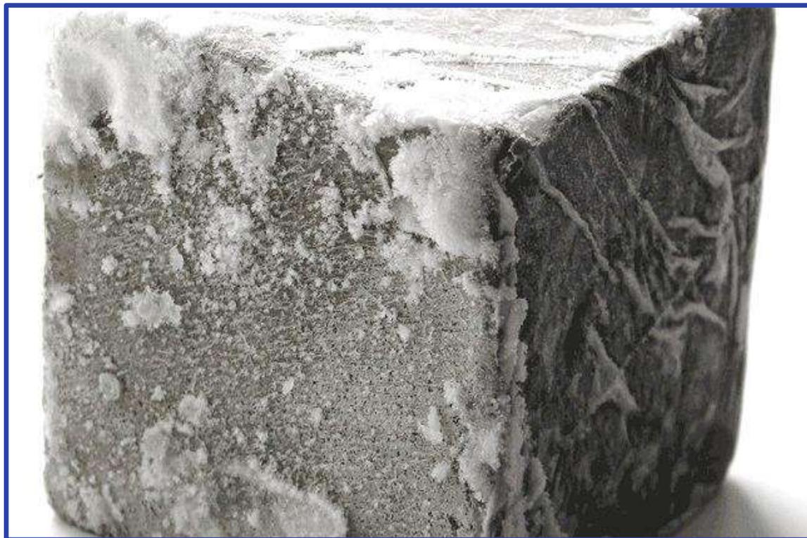
Повышает морозостойкость не менее, чем на 2 марки и позволяет получать бетоны с морозостойкостью **свыше F400**
