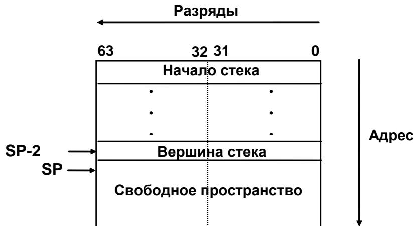
**Рисунок 5.1 - Конфигурация системного стека**
