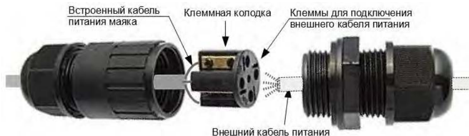
Рисунок 2 – Конструкция разъема
