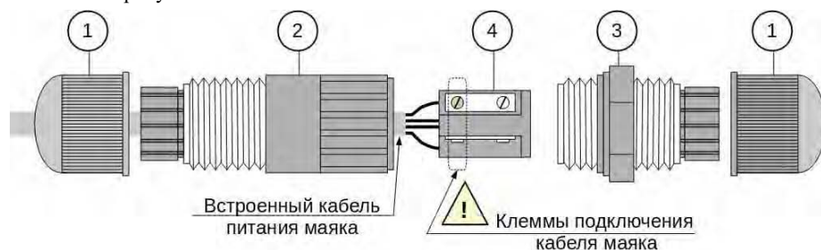
Рисунок 5 – Разъединение ответных частей корпуса разъема кабеля маяка
