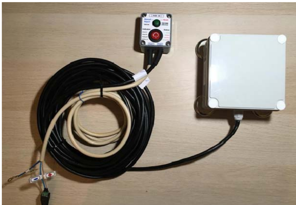
Рис. 6 - «Морской комплект Galileosky Base Block Iridium LITE» с коммутационной коробкой
