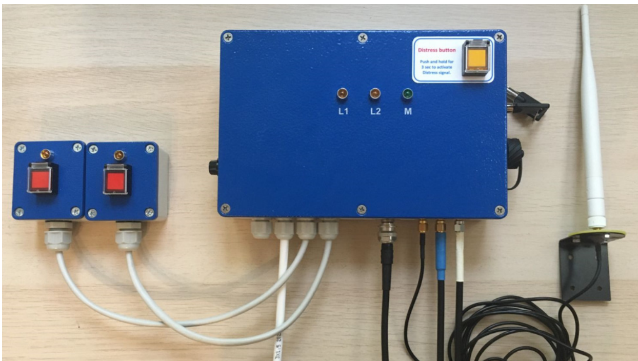
Прибор «COM-5» - прототип (основной блок, кнопки SSAS, доп. антенна Wi-Fi)
