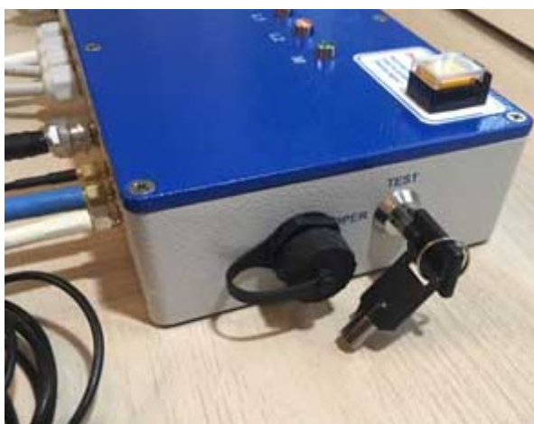
Ключ перевода режимов работы OPER/TEST (для SSAS)
