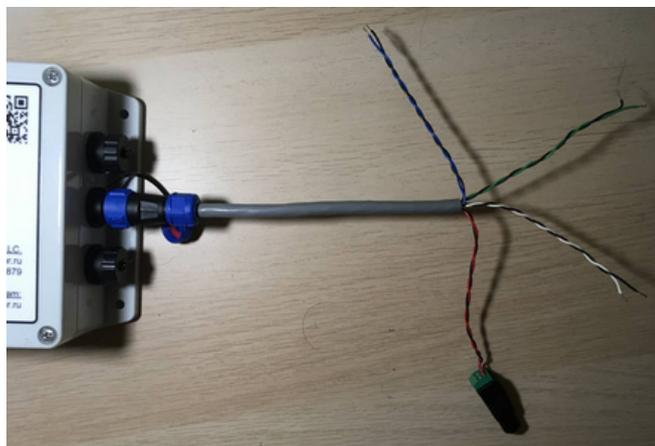
Рис. 10 - Кабель для разъема № 2 к трекеру из комплекта поставки
