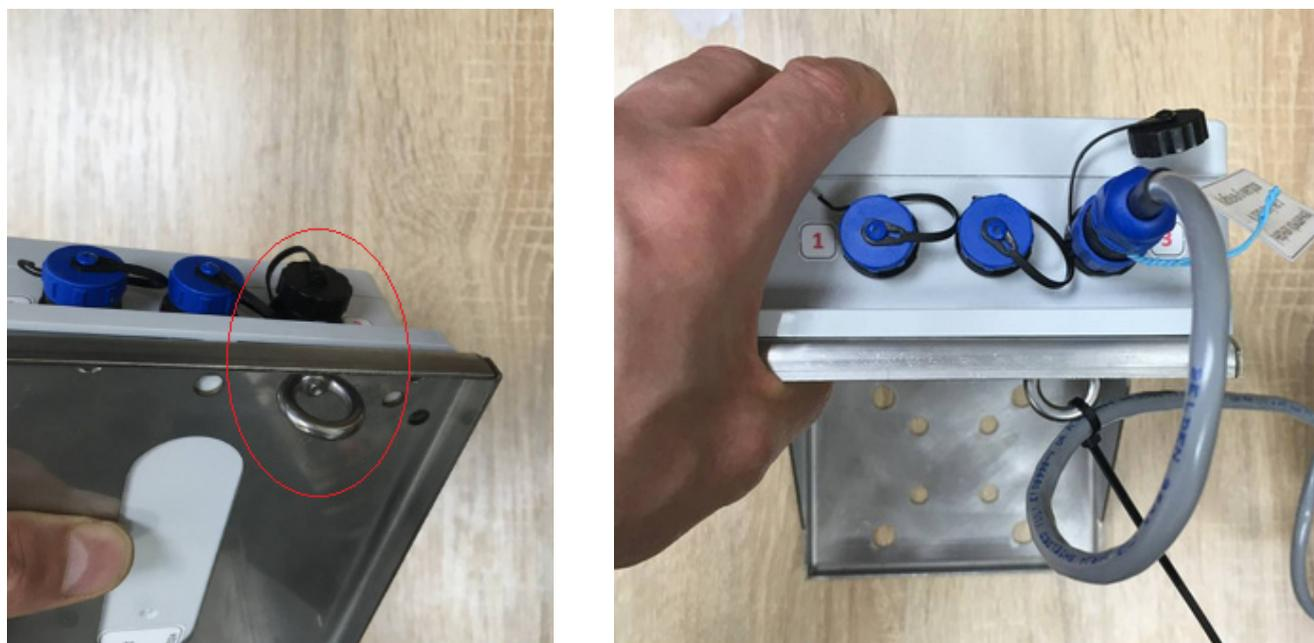
Рис. 13 - Крепление кабелей стяжками к рым-гайкам
