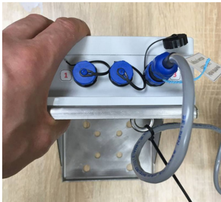
Рис. 11 - Крепление кабелей стяжками к рым-гайкам
