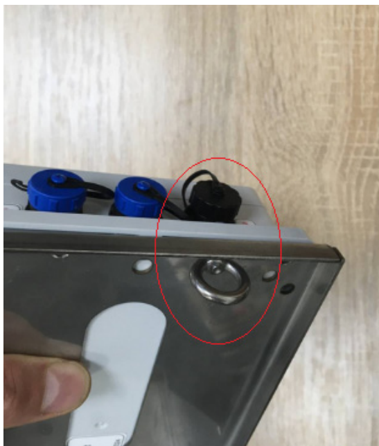
Рис. 11 - Крепление кабелей стяжками к рым-гайкам
